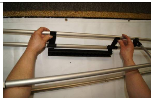
Schiene von außen ansetzen
