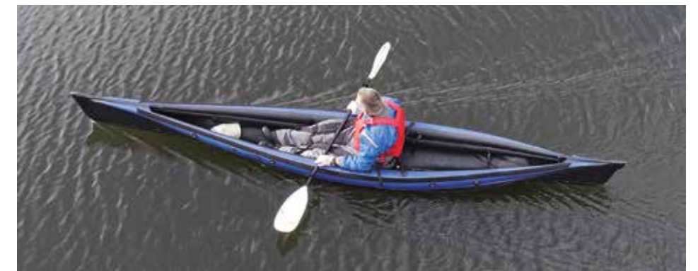
Das neue nortik scubi speed kann mit und ohne Verdeck gefahren werden. Der komfortable Sitz und die Schenkelstützen verbleiben beim Abbau im Boot. Vier Spanten und ein hoher Fülldruck verpassen dem neuesten scubi eine für ein Hybridboot große Steifigkeit.
