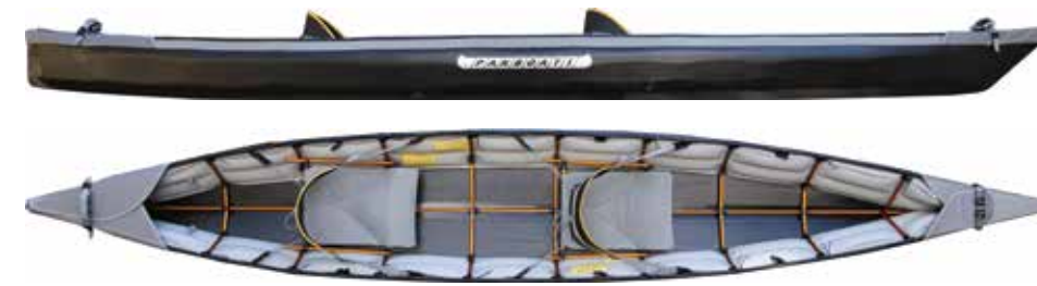
Das Puffin Saranac als Doppelsitzer ohne Verdeck. Gut zu erkennen: das clevere Gestänge-Konzept und die für Pakboats typischen Endkappen an Bug und Heck.
