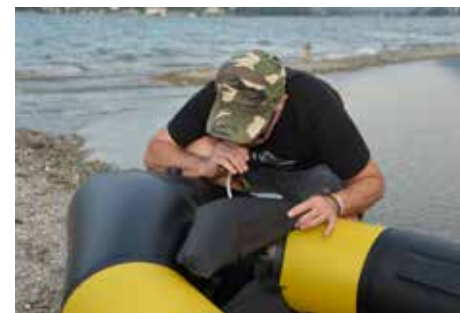
In drei Schritten einsatzbereit: erstens das Gepäck im Inneren der Luftschläuche verstauen. Zweitens das Boot mit dem Befüllsack und drittens den Sitz mit dem Mund aufpumpen.
