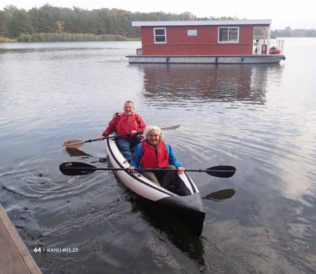
Das nortik scubi 2 folgt konsequent dem Hybridboot-Prinzip: Hochdruck-Luftschläuche und wenig Gestänge. Das Verdeck gibt's optional.
