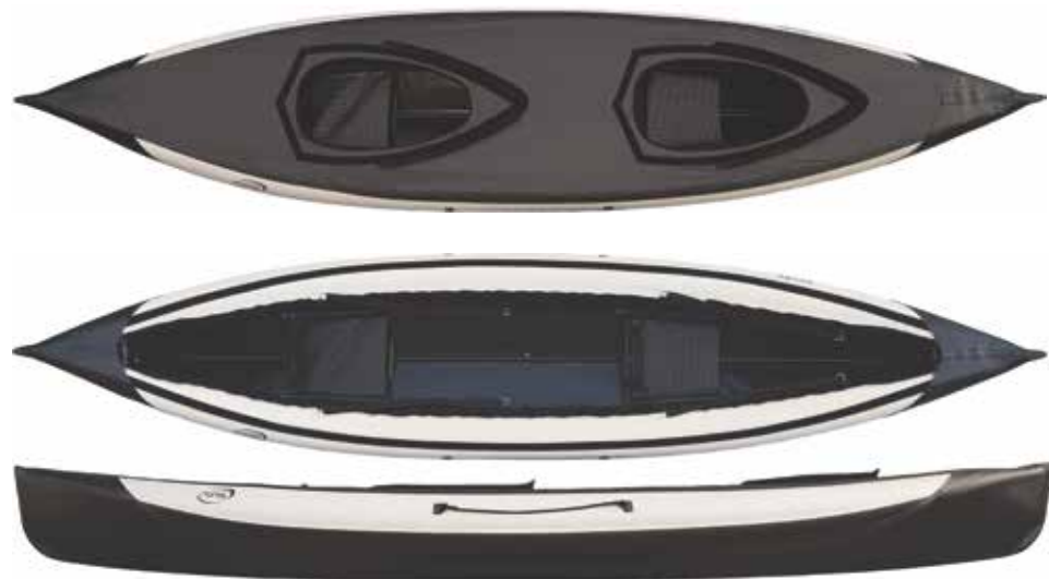
Das nortik scubi 2 folgt konsequent dem Hybridboot-Prinzip: Hochdruck-Luftschläuche und wenig Gestänge. Das Verdeck gibt's optional.
